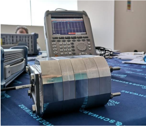
Figura 2 Análisis de las frecuencias de resonancias de una CRF usando un analizador de redes.
